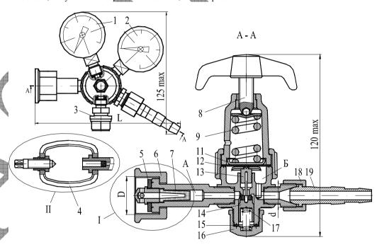
Рис. Редукторы баллонные одноступенчатые миниатюрного исполнения.
