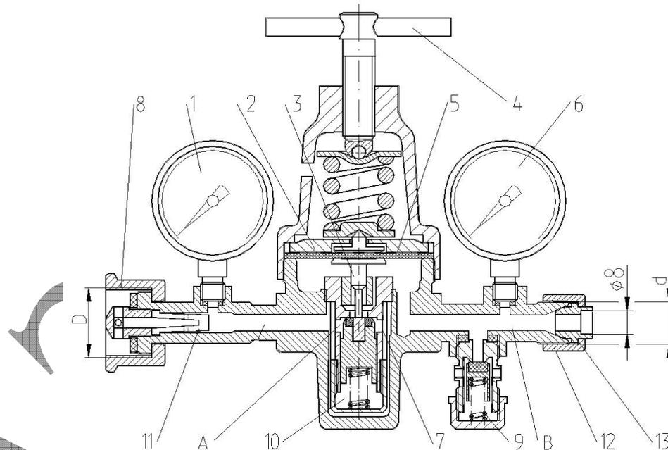
1, 6 – манометры; 2– направляющая; 3– толкатель; 4– винт регулирующий; 5– мембрана; 7, 11– фильтры; 8, 12– гайки накидные; 9– клапан предохранительный; 10– узел редуцирующий; 13– ниппель.
