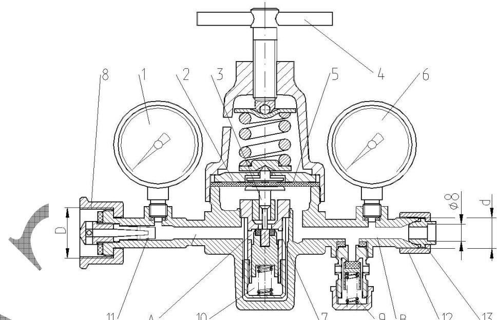
1, 6 – манометры; 2– направляющая; 3– толкатель; 4– винт регулирующий; 5– мембрана; 7, 11–фильтры; 8, 12–гайки накидные; 9–клапан предохранительный; 10–узел редуцирующий; 12, 13–ниппель.
